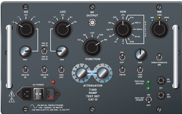
Figure 11-118. An ILS test unit.
